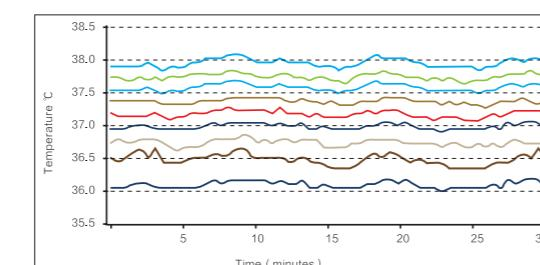
培养箱内腔温度均匀度  $\leq \pm 1.0^{\circ}\text{C}$ ，使所有样品受热均匀。
